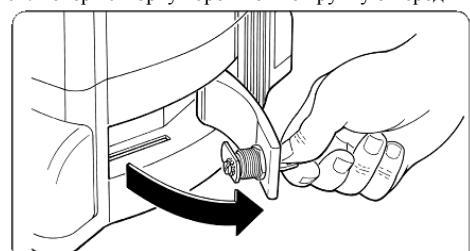
**05.** Чтобы восстановить нормальную работу системы автоматизации, переведите ручку в закрытое положение, поверните ключ в замочной скважине против часовой стрелки и вручную передвиньте створку ворот, пока не раздастся звук, подтверждающий, что створка ворот теперь управляема приводом.
