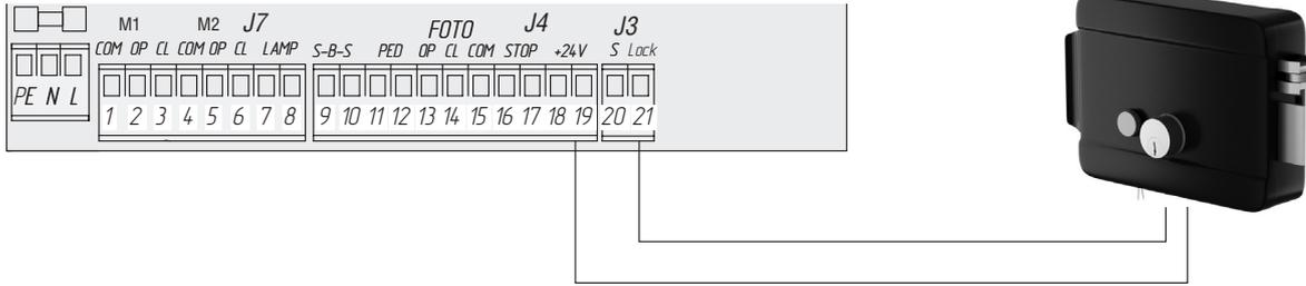
**Схема подключения электромеханического замка мощностью свыше 3А**
