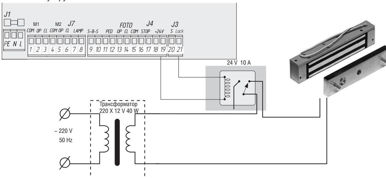
**Схема подключения электромеханического замка мощностью до 3А**
