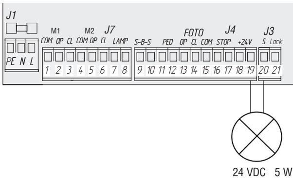
**Схема подключения дополнительного освещения**
