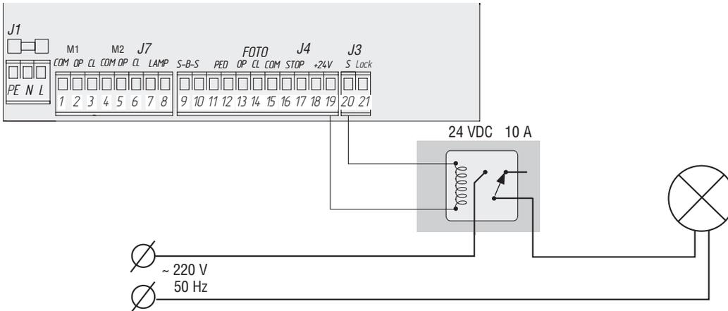
**Схема подключения дополнительного светофора**
